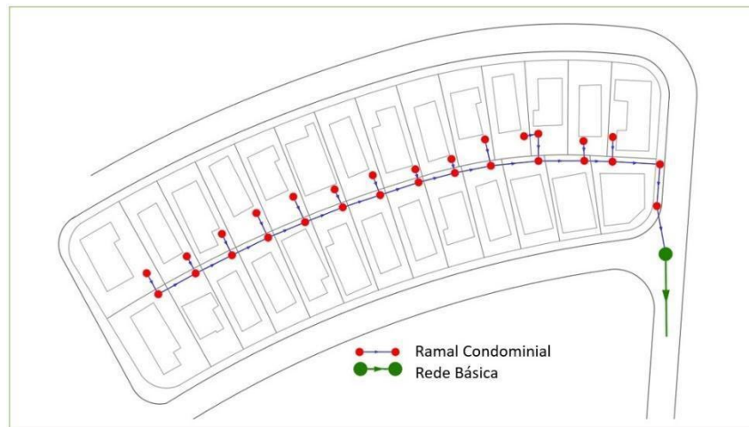
Figura 6: Modelo de ramal de fundo de lote.
